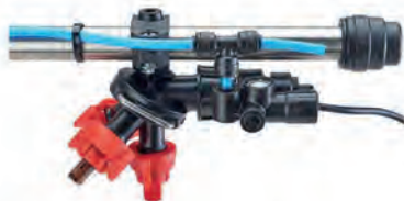
Spray-Stop Direct-Control Single. Das zugehörige INC-Modul 1fach steuert 4 Ventile gleichzeitig.
